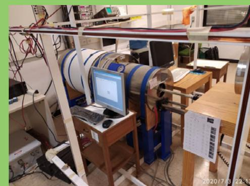
Figura 5. Magnetómetro superconductor 2G 755 de alta sensibilidad (10-12 A m<sup>2</sup>) con sistema desmagnetizador por campos alternos, utilizado para los análisis SIRM.
